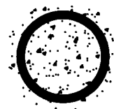
c) Ejemplo de sección transversal de pilotes inyectados
