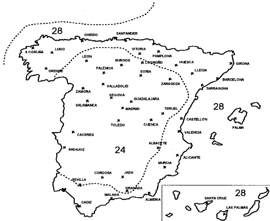
Fig. A.4. Velocidad de referencia del viento v_{ref} en [m/s]^2
