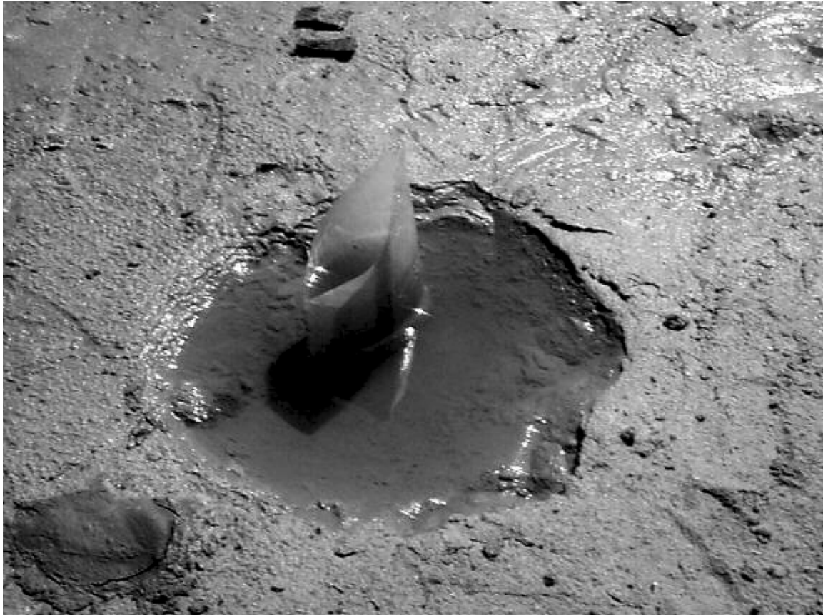
Figura A.12 – Ejemplo de manto drenante de material granular con insuficiente permeabilidad, mostrando el agua atrapada en el manto drenante, lo que implica presiones en el dren.
