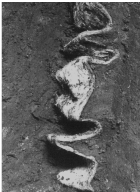
Figura A.5 – Pandeo de un dren debido a compresiones relativamente grandes de la turba
