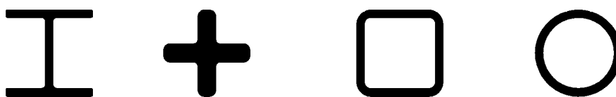
d) Ejemplo de secciones transversales de pilotes de acero
