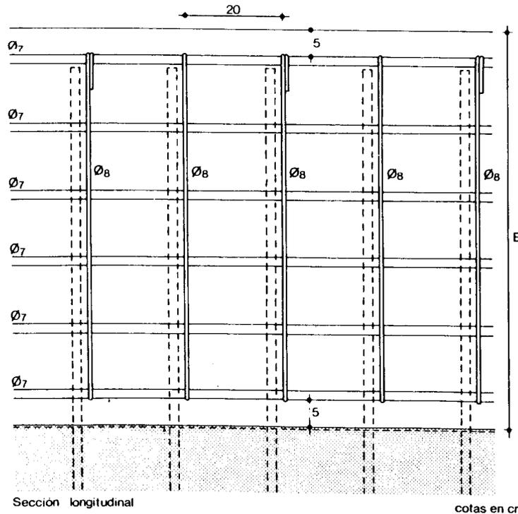
La cota final de hormigonado rebasará a la teórica al menos en 30 cm. Este exceso en su mayor parte contaminado por el lodo, será demolido antes de construir la viga de atado de los paneles. Si la cota teórica coincide con la coronación de muretes se deberá hacer rebasar el hormigón hasta comprobar que no está contaminado.
