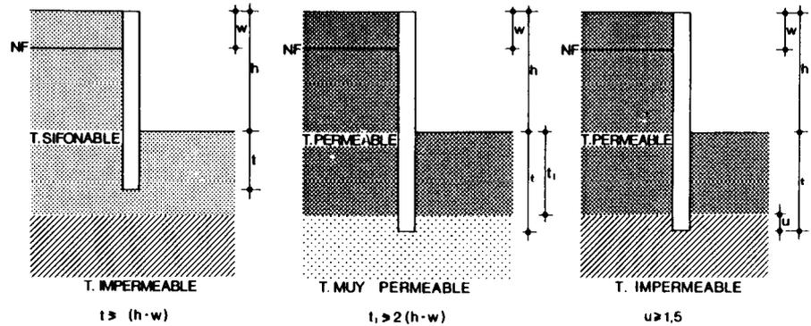
En terrenos sifonables (arenas finas) la profundidad de la pantalla por debajo del fondo de la excavación deberá ser, al menos, igual a la altura del nivel freático sobre dicho fondo, salvo que la pantalla penetre en un estrato impermeable.
