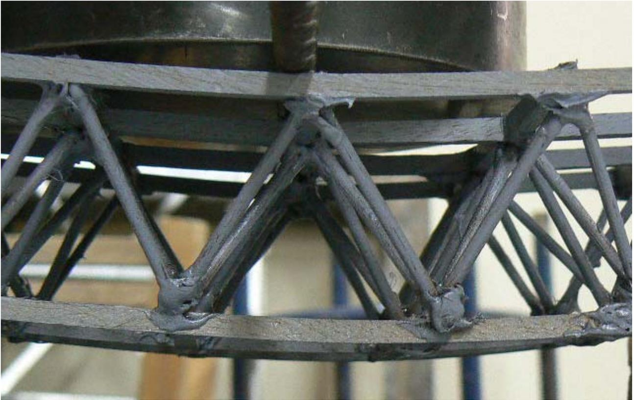
REALICE UNA TRIODÉTICA Y LA SOMETI A ESFUERZOS BAJO UNA CARGA UNIFORMEMENTE REPARTIDA, VIENDO SUS RESPECTIVOS COMPORTAMIENTOS A COMPRESIÓN Y TENSIÓN.
