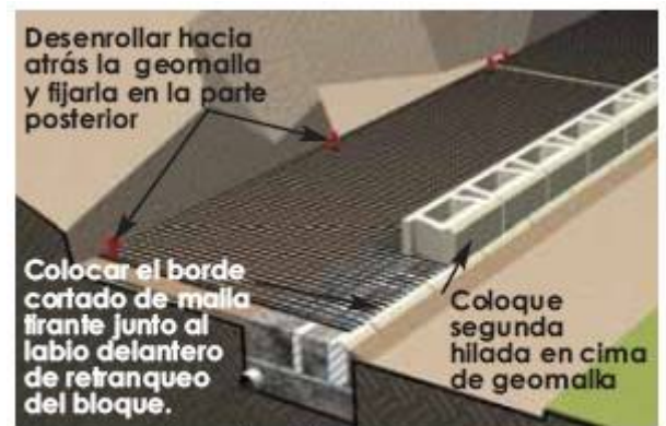
Instalación y fijación de la geomalla.
