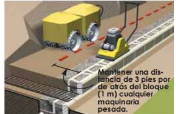
Mantener una distancia de 3 pies por de atrás del bloque (1 m) cualquier maquinaria pesada.
