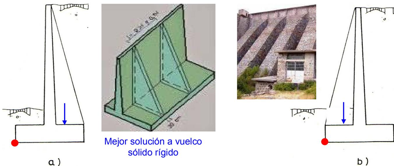
La primera solución es técnica y económicamente mejor, por disponer el alzado en la zona comprimida de la sección en T que se forma.
