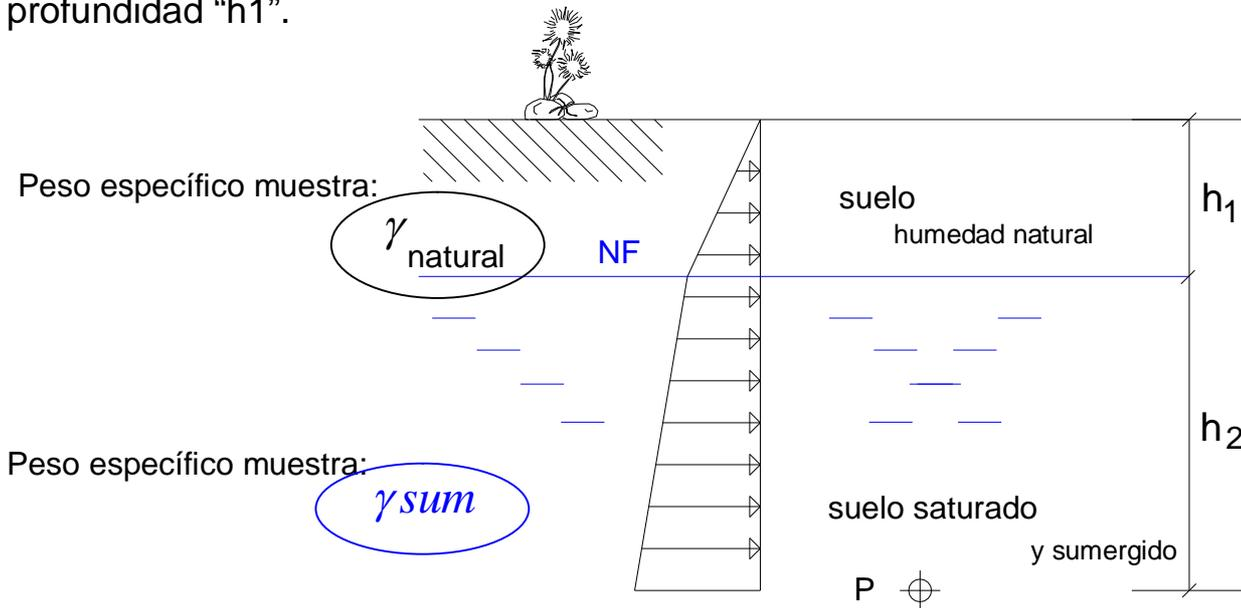
El cálculo de las tensiones verticales es distinto por encima y por debajo del nivel freático (NF).
