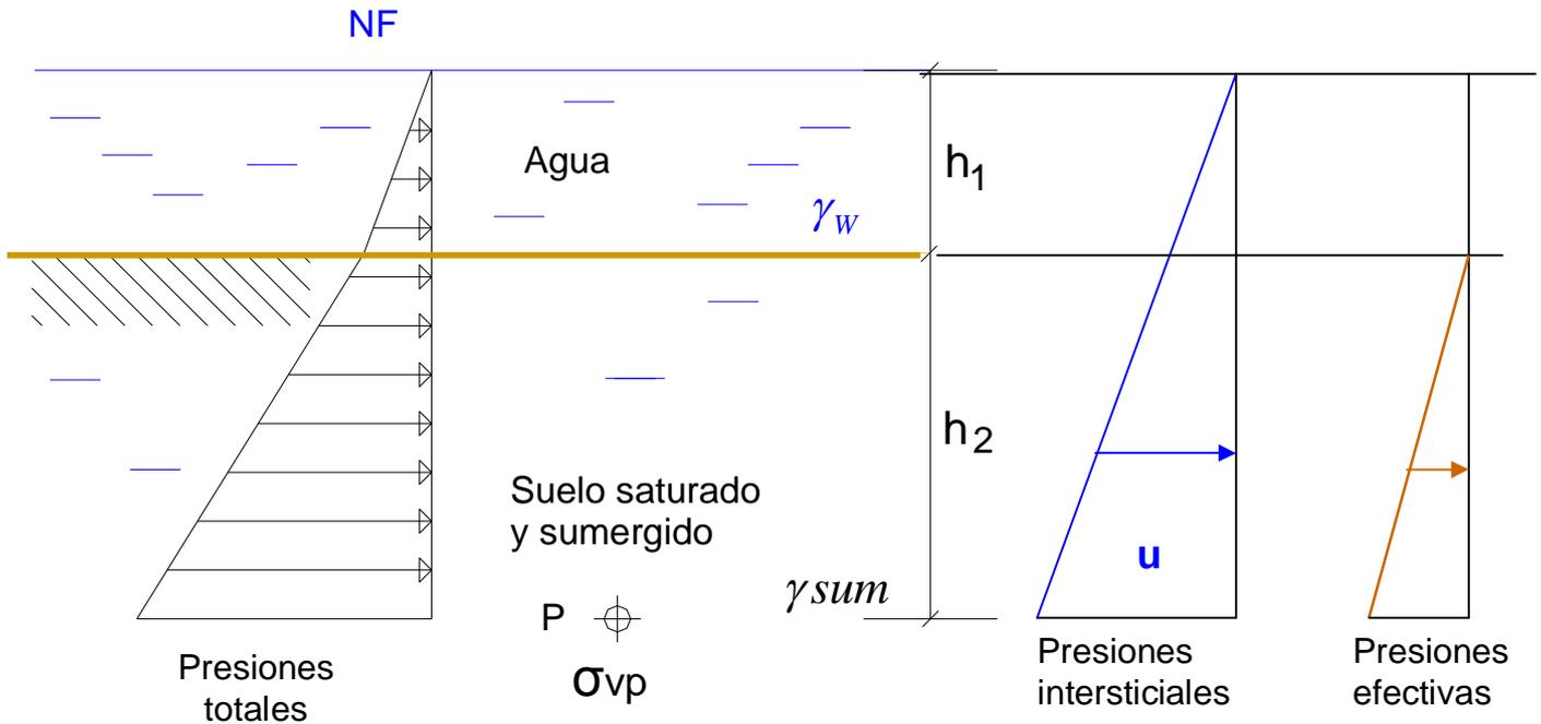
En el punto "P" del terreno la tensión total vertical es:  $\sigma_{v_P} = [(h_1 * \gamma_w) + (h_2 * \gamma_{sat})]$
