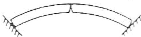
Si el empuje del arco no es soportado por sus elementos extremos el arco se abre separándose sus apoyos laterales.
