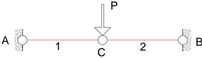
No se puede descomponer P en las direcciones A - C y B - C
