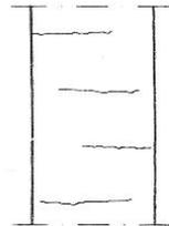
Pilar de hormigón en tracción.
